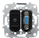
Механизм с комбинированными разъёмами VGA + mini-jack, 3,5 мм С лицевой стороны: 1 разъём VGA (тип: DE-15) и 1 разъём mini-jack (аудиоразъём, 3,5 мм, стерео). С обратной стороны: VGA — винтовые клеммы (15 проводов); mini-jack, 3,5 мм, — винтовые клеммы. Без монтажных лапок. Накладки: арт. 8555.4.
